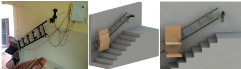
صورة 5 - صورة 6 - صورة 7 - الصور توضح شكل مصعد الدرج القابل للطي
